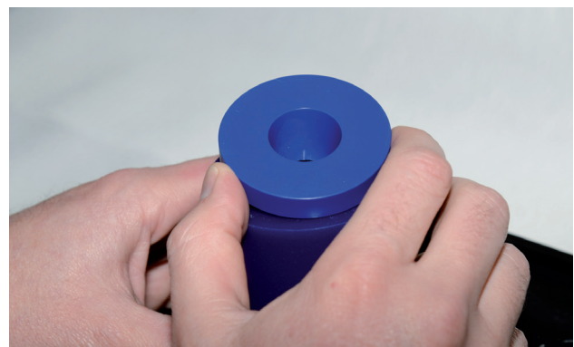
Fig. 4: Muffola con modellatore del corpo della muffola
