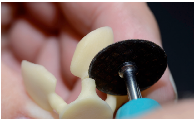
Fig. 9: Separazione del canale di pressatura
